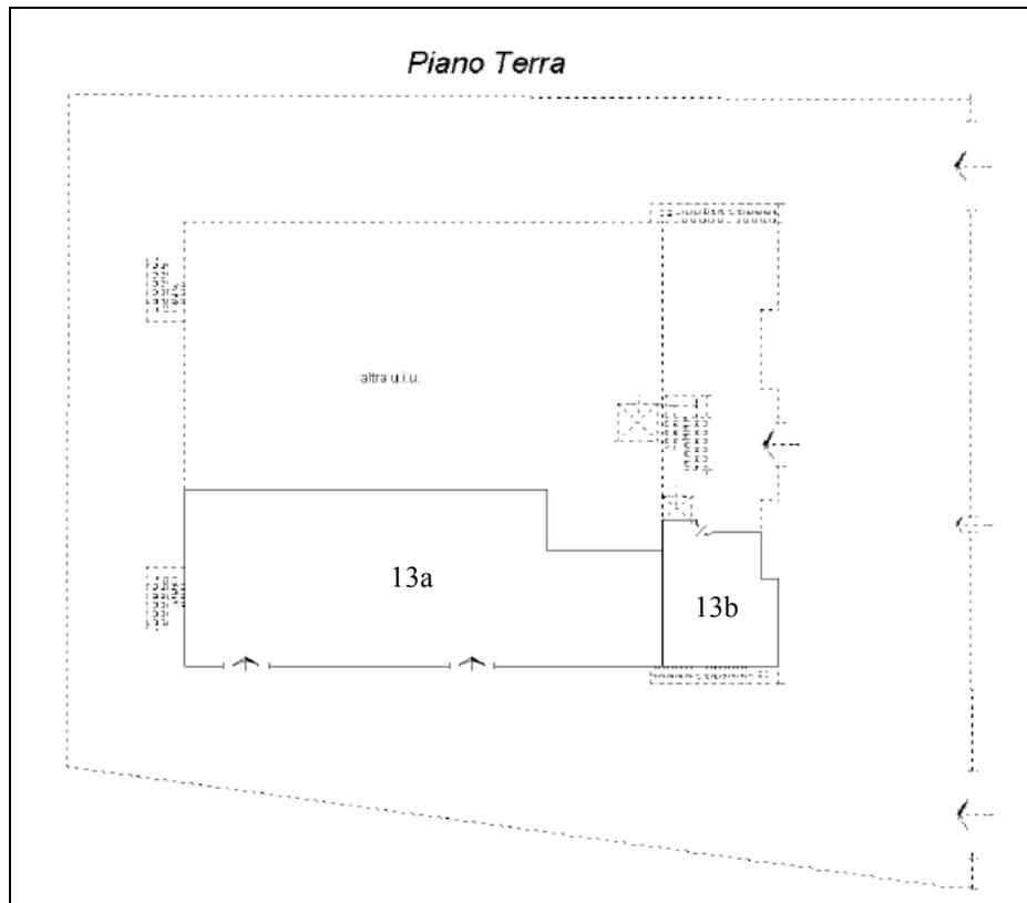
**Figura n° 7. Elaborato planimetrico per la variazione catastale di divisione del subalterno 13 della particella 378 in due unità immobiliari indipendenti.**
