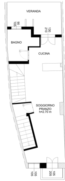
Fig.2: Pianta piano primo stato di fatto
