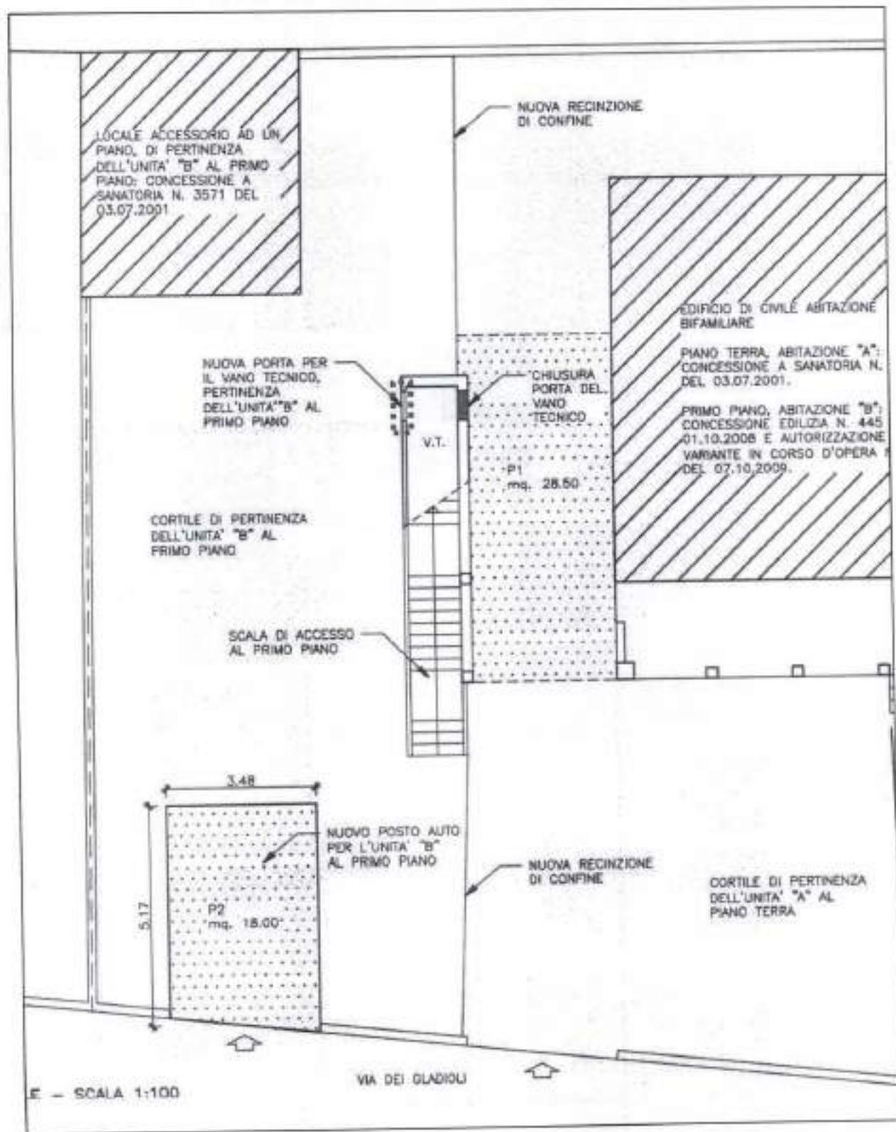
Figura 8 - Subalterno 1 - Piano Terra - Planimetria stato di progetto - Autocertificazione del 2001
