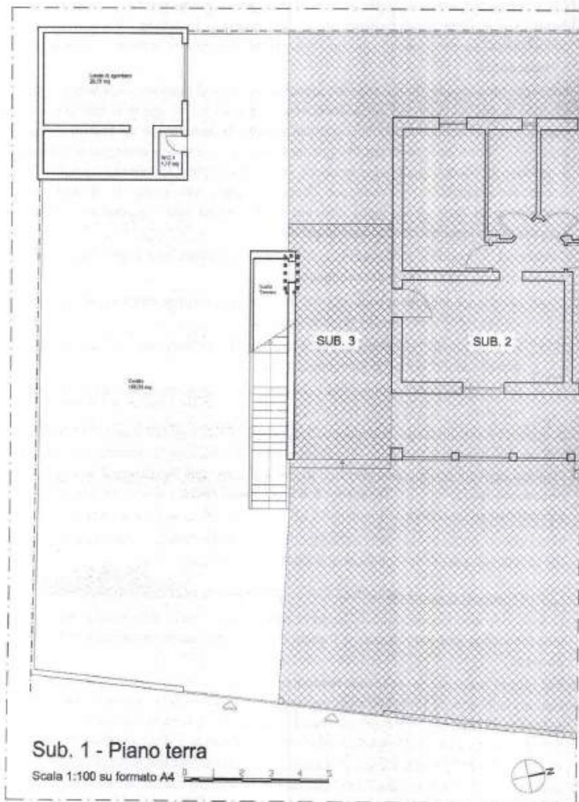
Figura 7 - Subalterno 1 - Piano Terra - Planimetria dello stato di fatto rilevato con evidenziati gli elementi difformi rispetto a quanto approvato
