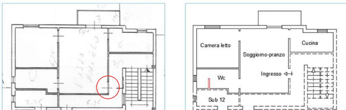
Figure 8 – A sx stralcio dell'elaborato grafico della concessione edilizia, a dx restituzione grafica dello stato dei luoghi
