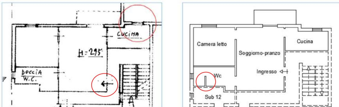
Figure 7 – Confronto tra la Planimetria catastale (Sx) e restituzione grafica dello stato dei luoghi (dx). In rosso le difformità riscontrate
