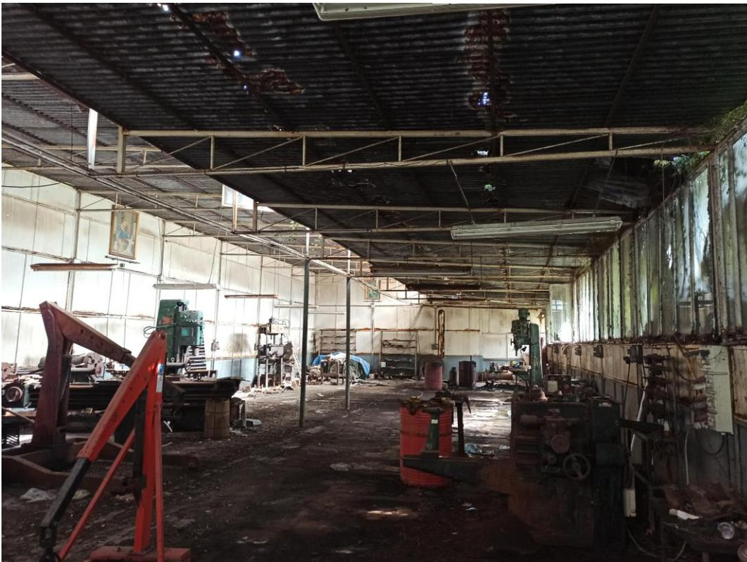
Il capannone, destinato a torneria, realizzato con profilati in ferro e copertura in lamierino, occupa un'area di circa 246 mq catastali. Il pavimento è in battuto di cemento. L'impianto elettrico è dismesso. All'interno sono ancora presenti vecchi macchinari per la lavorazione del ferro. Lo stato d'uso dell'immobile e dei macchinari è pessimo. Le strutture sono arrugginite e dalla copertura provengono infiltrazioni.
