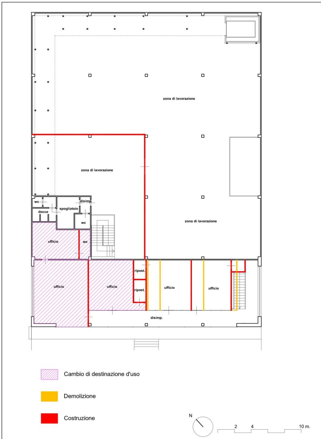
Fig. 22 - Confronto tra il progetto di variante relativo alla concessione edilizia n. 35/2006 e lo stato di fatto. Primo piano.
