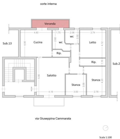
Rilievo dello stato di fatto attuale dell'appartamento con difformità rispetto alla planimetria catastale e al progetto autorizzato (ALL. 8)
