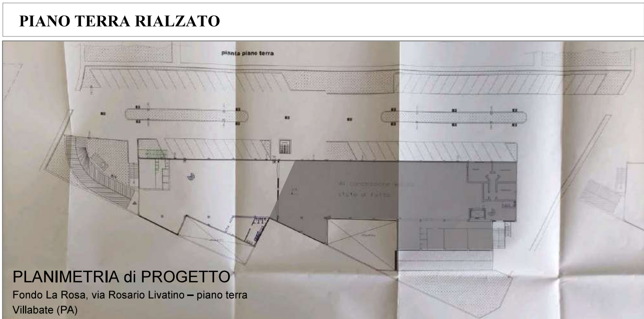
Planimetria di progetto in variante, piano terra. In tratteggiato la vecchia disposizione dei servizi.
