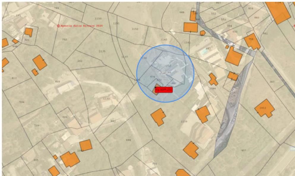
*Sovrapposizione del catastale alla cartografia tecnica comunale. Si evidenzia l'inserimento in mappa della particella al C.T. Vi è una distorsione nella sovrapposizione dovuta ai due diversi sistemi di restituzione grafica delle carte Gauss Boaga- Cassini Soldner.*
