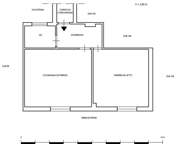
**Planimetria di rilievo dello stato di fatto**
