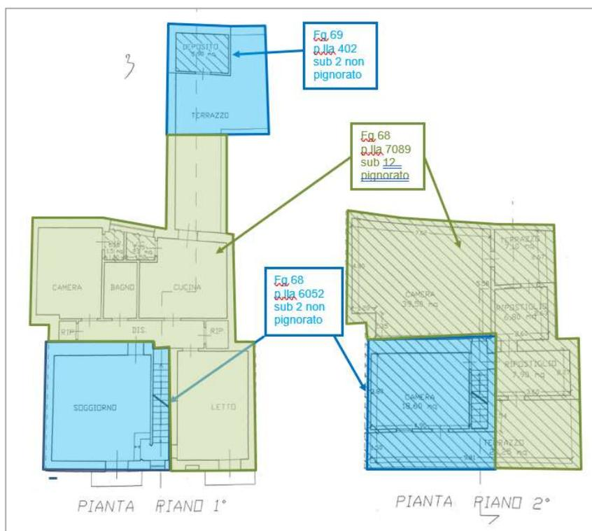
Durante il sopralluogo sono state riscontrate delle difformità rispetto alla tavola di progetto approvata, tali difformità consistono nella realizzazione di un tramezzo per creare un nuovo bagno in una parte del ripostiglio del secondo piano e nella realizzazione di un varco nel muro portante per poter accedere al nuovo wc.
