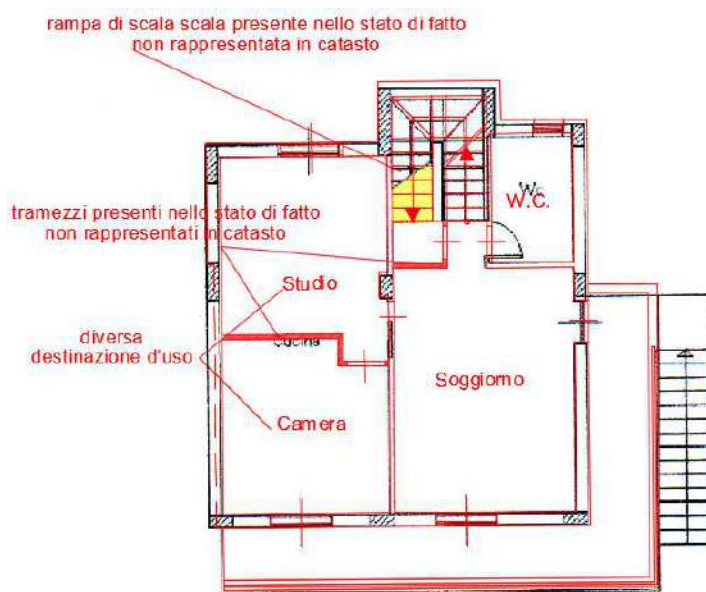
Fig.13 – Sovrapposizione delle planimetrie di rilievo con la planimetria catastale relativa al piano terra
