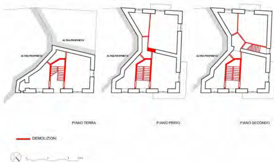
Abitazione cielo/terra - schema delle demolizioni
