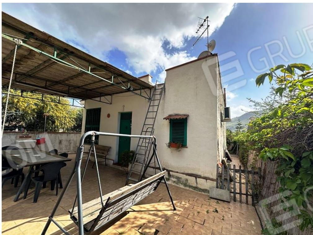
***Prospetto principale - evidenti segni di umidità di risalita dovuti allo scarso isolamento dal terreno.***
