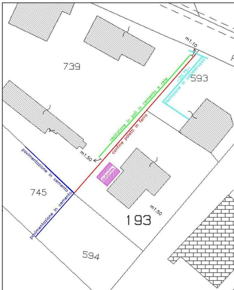
Nelle more di tale verifica dei confini è stato possibile confermare la corretta posizione del fabbricato all'interno mp. 193, e rilevare l'esistenza di un'autorimessa fuori terra, realizzata in pannelli sandwich, tra il sopraccitato fabbricato ed il confine Ovest della proprietà con il mp. 739.
