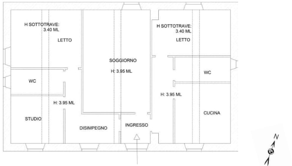
**Figura 14 : Planimetria stato reale e rilevato Piano Terra Subalterno 1**
