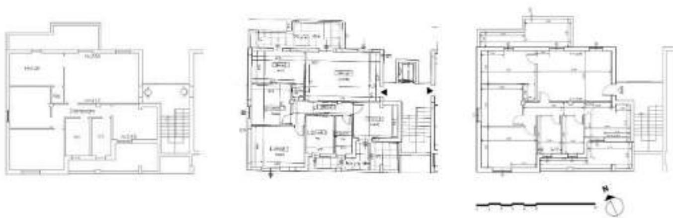
**a** - Pianta estratta dalla planimetria catastale (Al. 1) - **b** - Pianta estratta dal progetto autorizzato con Permesso a Costruire n.50/2011 (Al.4) **c** - Pianta dell'accertato stato di fatto derivata dalla restituzione grafica degli eseguiti rilievi architettonico-geometrici
