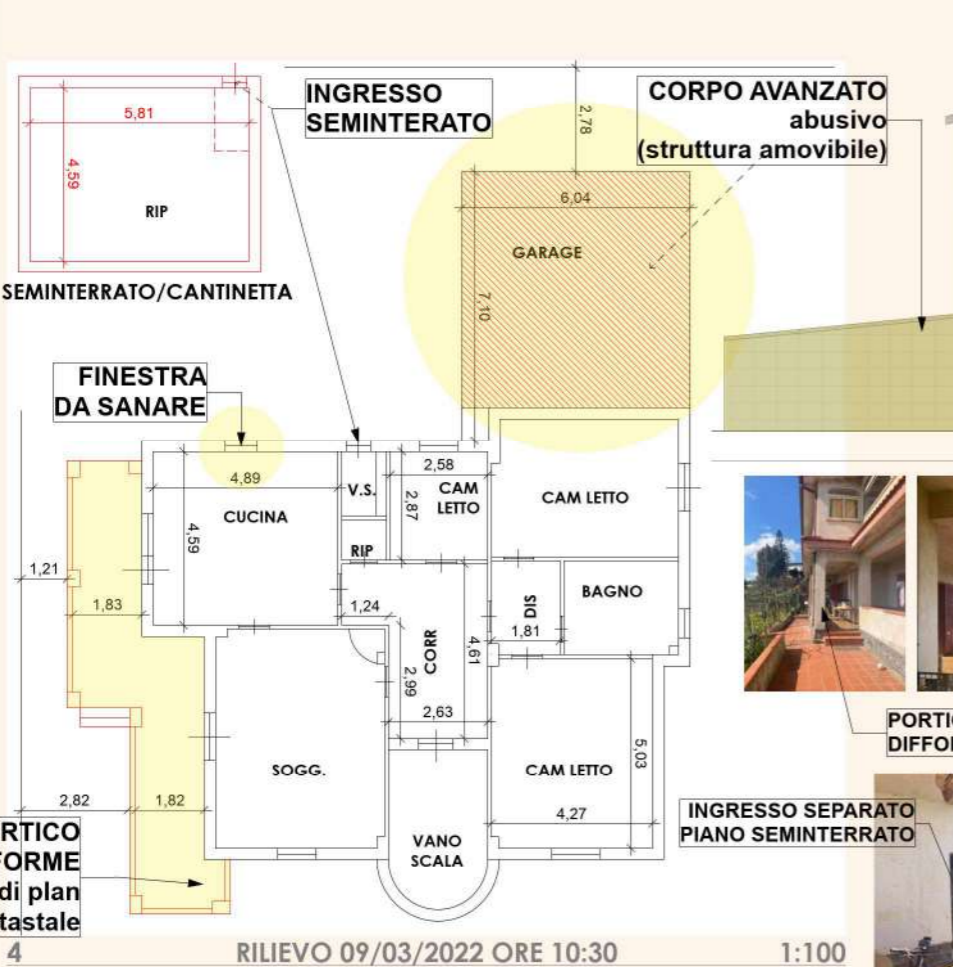
0. PLANIMETRIA PIANO TERRA- STATO DI FATTO (RILIEVO) 1:100
