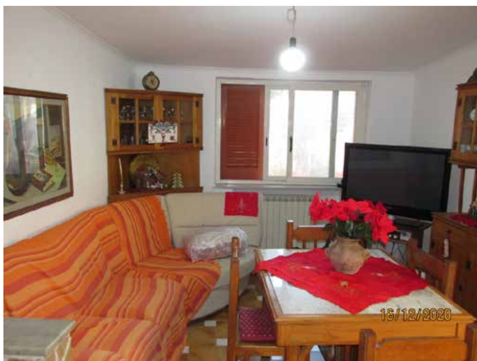
Fotografia 28 – Soggiorno/Pranzo: L'ambiente è dotato di una finestra esposta a sud, con affaccio sul cortile comune, è munita di infisso in alluminio con vetro camera e protetta dall'esterno da serramenti in ferro di tipo "persiane alla napoletana".
