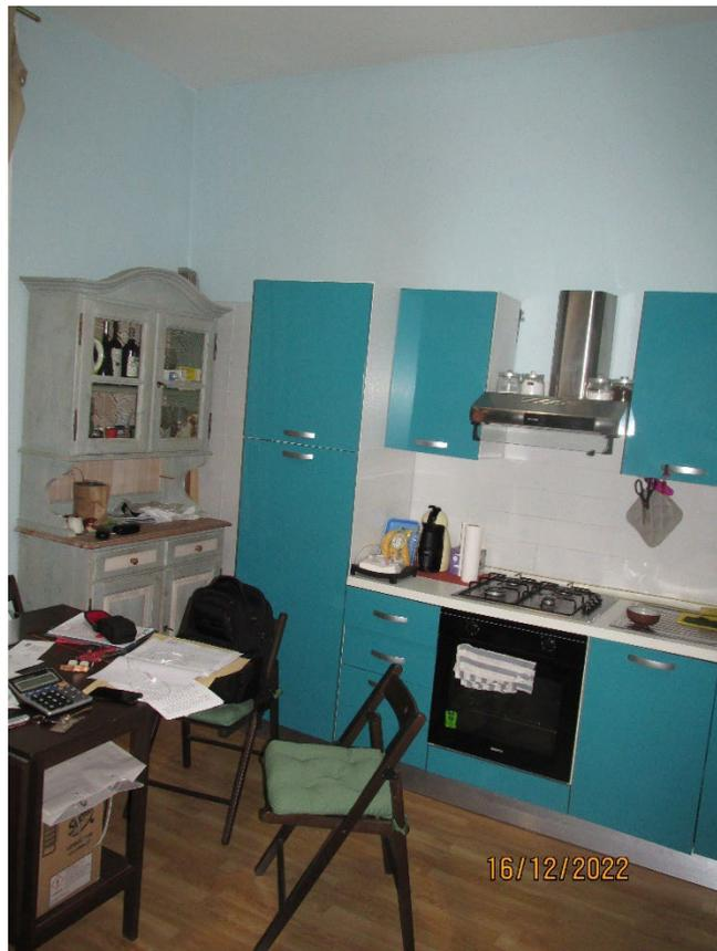
**Fotografia 35** – *Cucina/Soggiorno*: La pavimentazione è costituita da listelli in laminato effetto legno; le pareti sono rivestite con intonaci ordinari a finitura liscia e tinteggiate con pittura lavabile ad eccezione del tratto di parete su cui è alloggiato l’angolo cottura che risulta nella parte centrale rivestita con piastrelle di ceramica smaltata.
