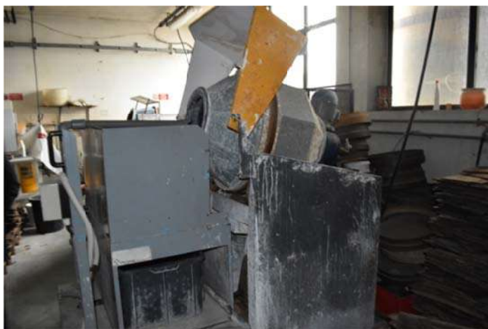
32 – Buratto ad acqua con pompa scarico
