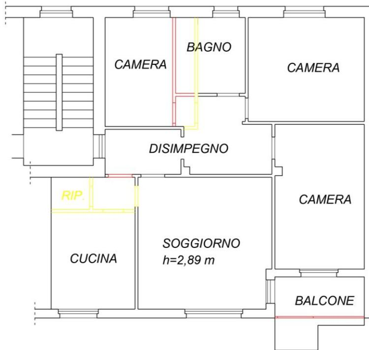
Pianta piano terzo con indicate le difformità rilevate rispetto la scheda catastale
