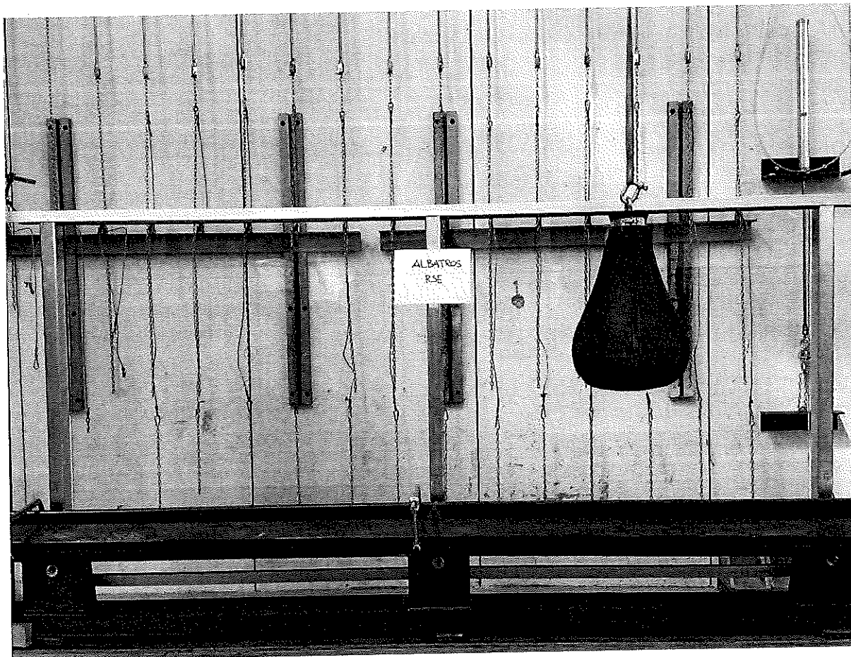
Fotografia del campione dopo urto al centro del tamponamento.
