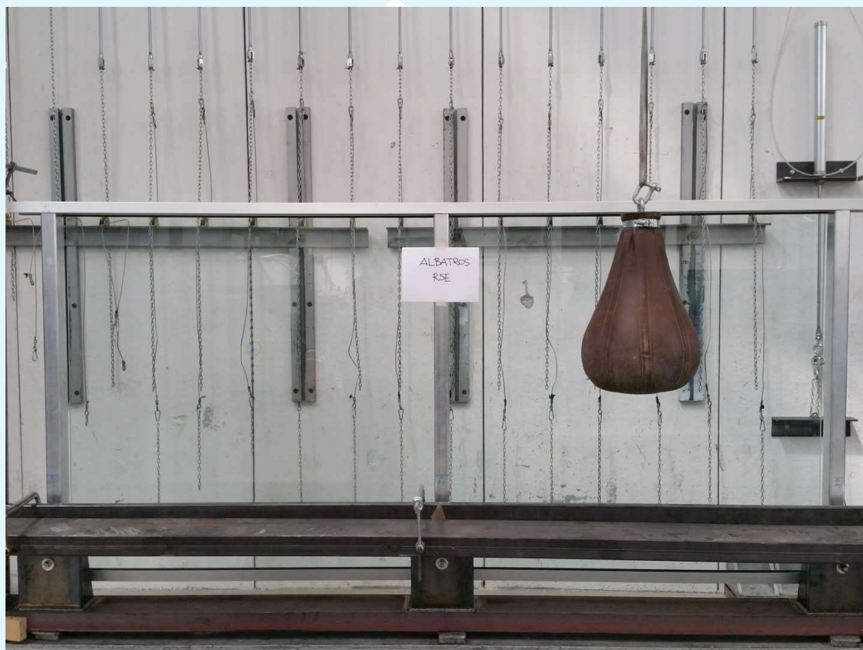
Fotografia del campione dopo urto al centro del tamponamento.
