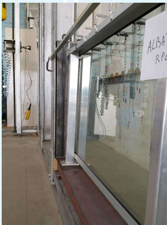
Fotografia del campione sottoposto a carico statico lineare orizzontale.
