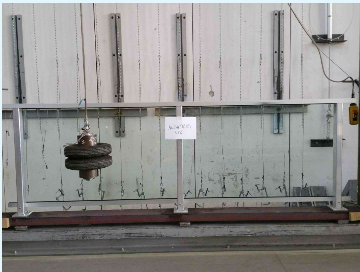
Fotografia del campione dopo urto di energia 600 J al centro del tamponamento.
