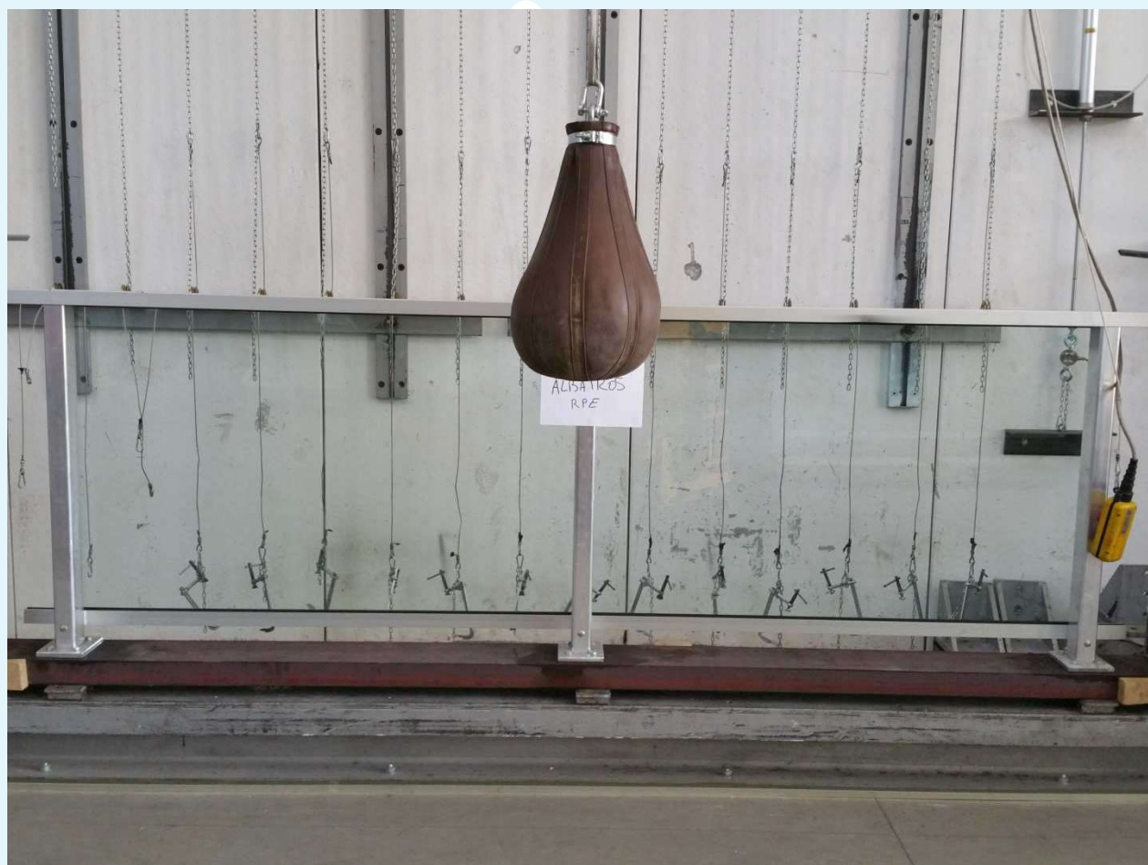
Fotografia del campione dopo urto sul corrimano in corrispondenza del montante centrale.
