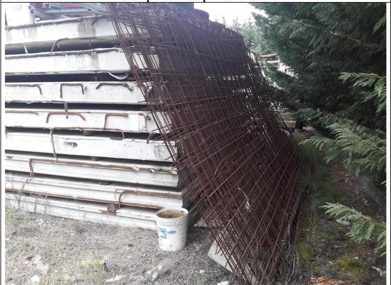
**8 – Reti elettrosaldate  $\varnothing = 5$  mm: n. 8 – dimensioni m 2.40 x m 3.80**
