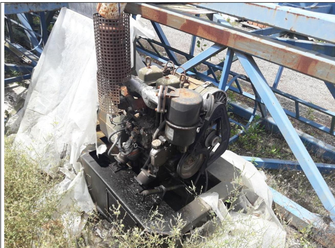
**45 – Motore VM tipo 1052, n. 219454, potenza massima cv 23, giri min. 1.500**
