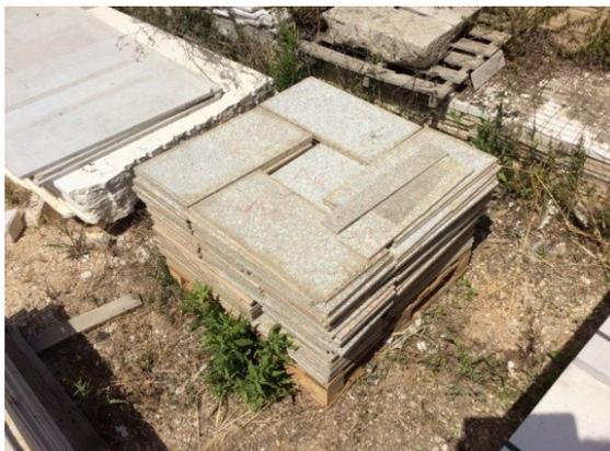
**A16 - PAVIMENTAZIONE DI GRANITO** dello spessore di cm. 1,5
