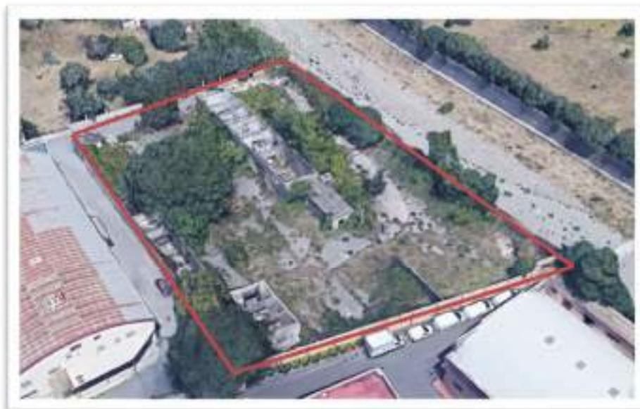
Nel caso di specie, considerato che i fabbricati che costituiscono il lotto sono collabenti è possibile prevedere il recupero edilizio del complesso industriale mediante ristrutturazione edilizia di demolizione e ricostruzione dell'esistente e completamento secondo le prescrizioni previste dallo strumento urbanistico, essendo antieconomica la ristrutturazione finalizzata al recupero dell'esistente.
