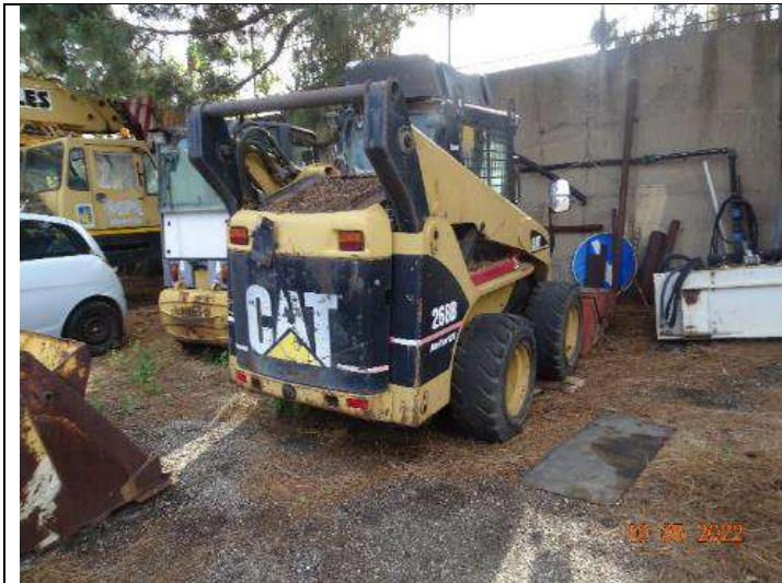
Figura 13: Skid loader CATERPILLAR mod. 268B con spazzolone, fresa e benna
