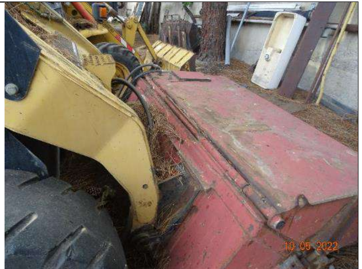
Figura 13: Skid loader CATERPILLAR mod. 268B con spazzolone, fresa e benna
