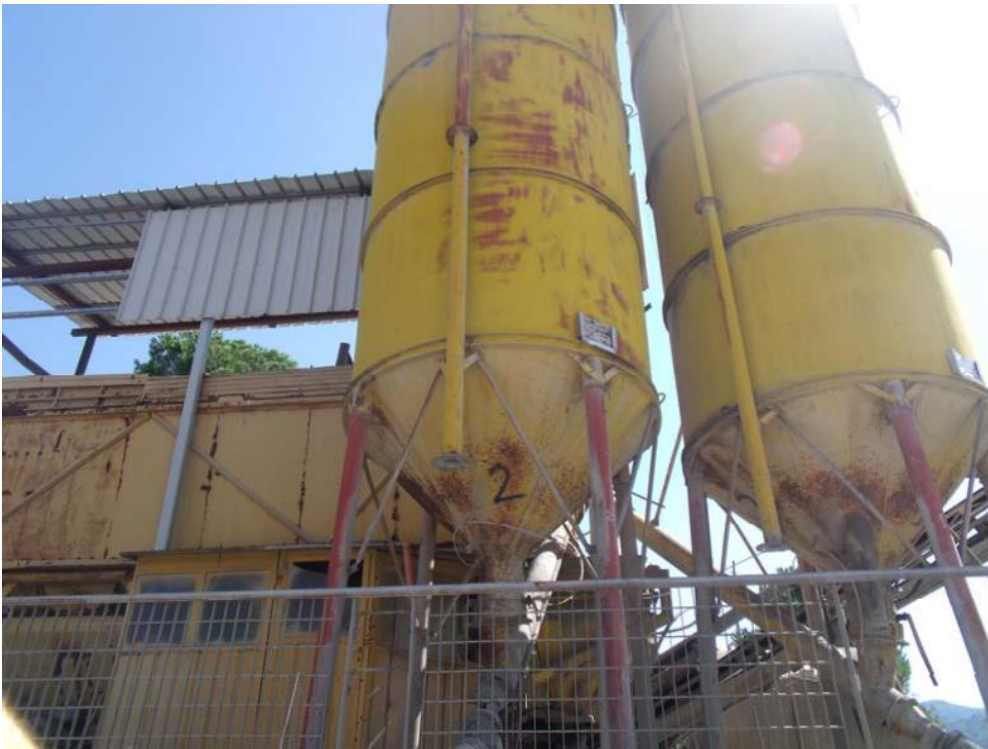
Foto n. 66: Coclea DN273 di lunghezza pari a 13,00 metri.
