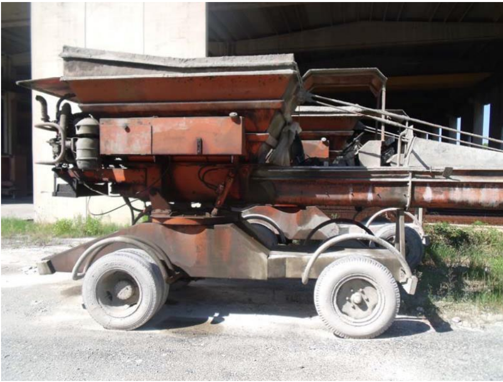
Foto n. 54: Macchina operatrice "Spidy" per getto calcestruzzo
