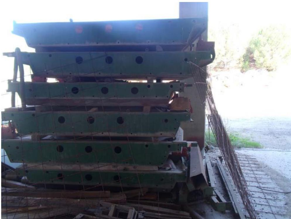
**Foto n. 72:** Elementi superiori di testata per travi.
