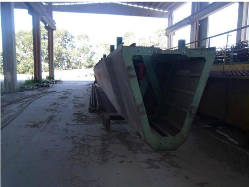
**Foto n. 10:** Secondo tampone con elementi di confino per cassero a “V” 160 – 180
