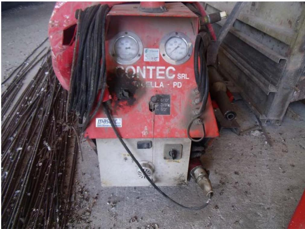
Foto n. 35: Tesatrice con copertura ignifuga
