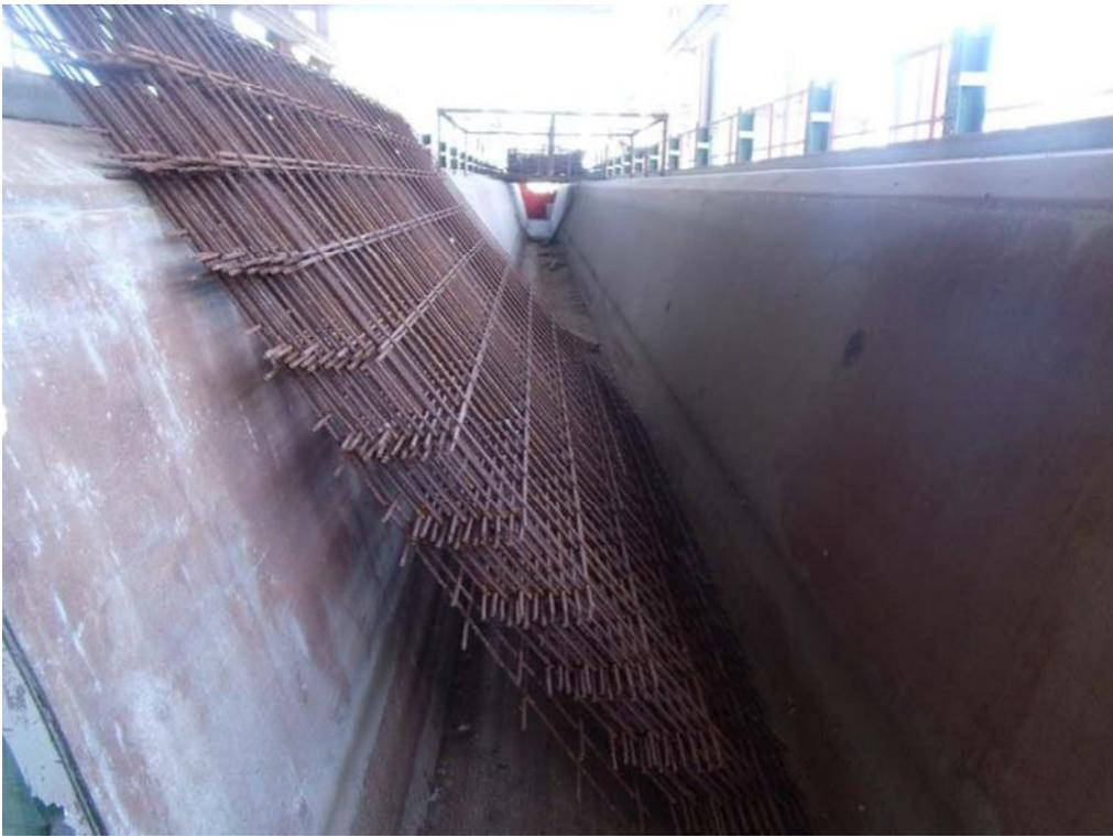
**Foto n. 13:** Cassero per travi a "V" 160 – 180 di lunghezza pari a metri 40,00
