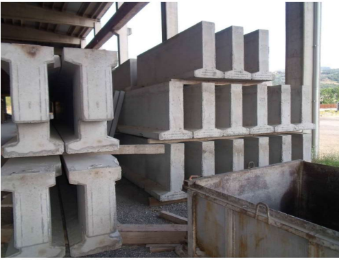
Foto n. 19: Elementi prefabbricati tipo New Jersey
