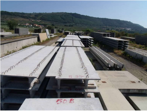
Foto n. 41: Coppelle prefabbricate bi-nervate
