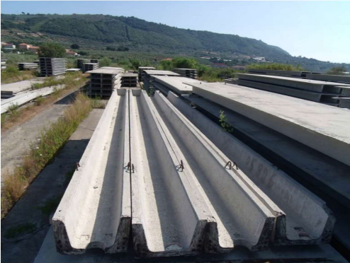
Foto n. 43: Numero quattro gronde prefabbricate
