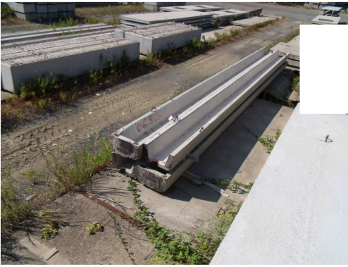
Foto n. 44: Numero quattro gronde prefabbricate
