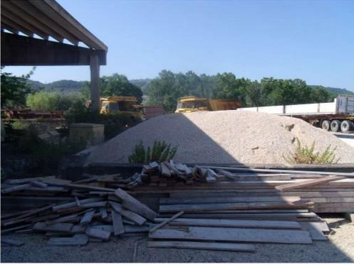
**Foto n. 85:** Inerti del diametro compreso tra 5 e 10 millimetri
