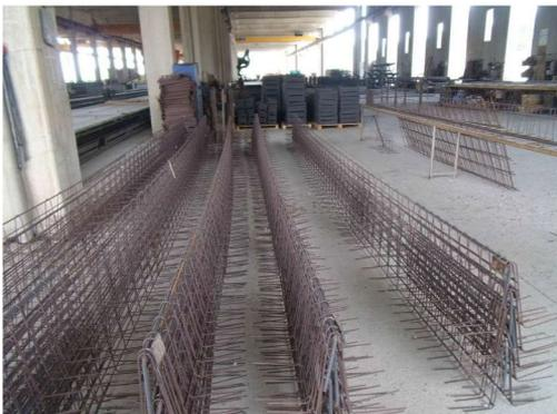
Foto n. 111: Rete elettrosaldata già piegata per nervatura del diametro pari a 5 millimetri
