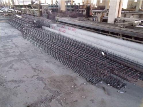
**Foto n. 98:** Due gronde di lunghezza rispettivamente pari a 8,25 metri e 7,98 metri e gabbie di armatura di acciaio lavorato per travetti prefabbricati
