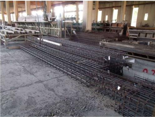
**Foto n. 99:** Gabbie di armatura di acciaio lavorato per travetti prefabbricati
