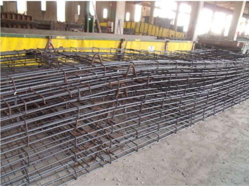
**Foto n. 14:** Armature pannelli di tamponamento
