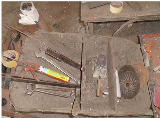
Foto n. 101: Accessori di piccola taglia e materiale da lavoro vario (elettrodi di vario tipo, dischi per smerigliatrici, martelli, pinze, tenaglie, nastri adesivi)
