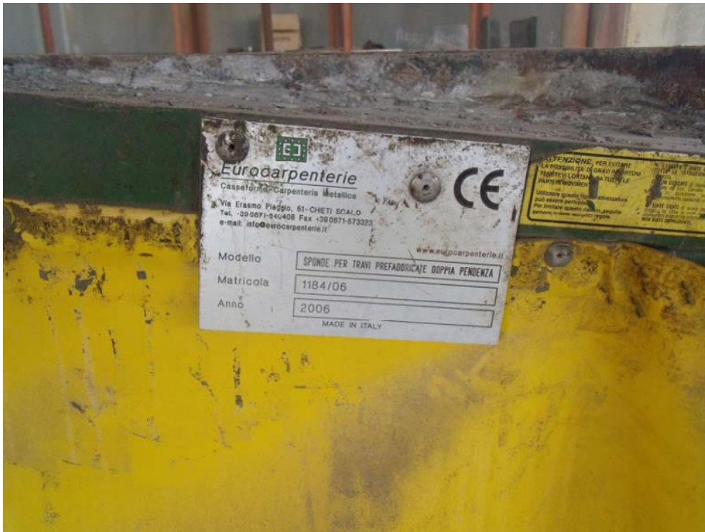
Foto n. 24: Sponda per trave a doppia pendenza
