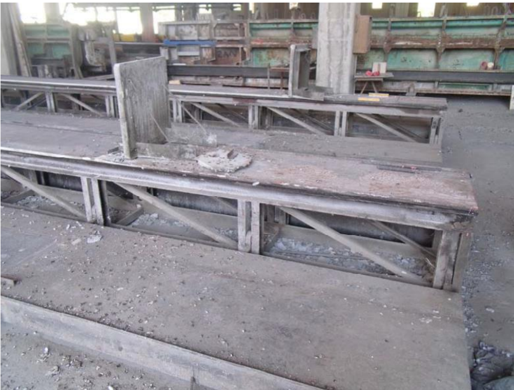
Foto n. 39: Casseri per pilastri prefabbricati.
