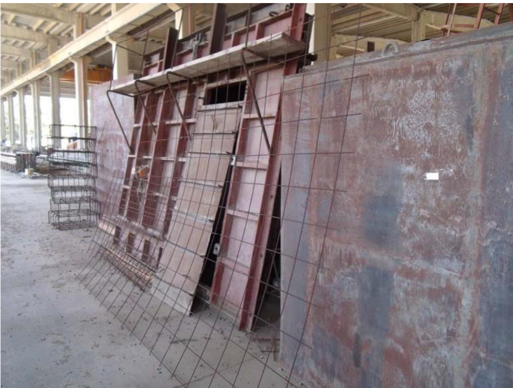
Foto n. 43: Cassero per la costruzione di box.
