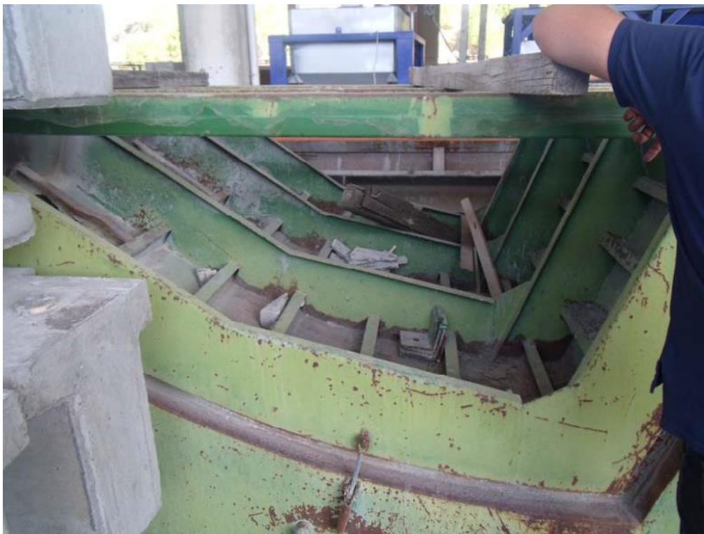
Foto n. 45: Cassero per gusci di rivestimento da ponte
